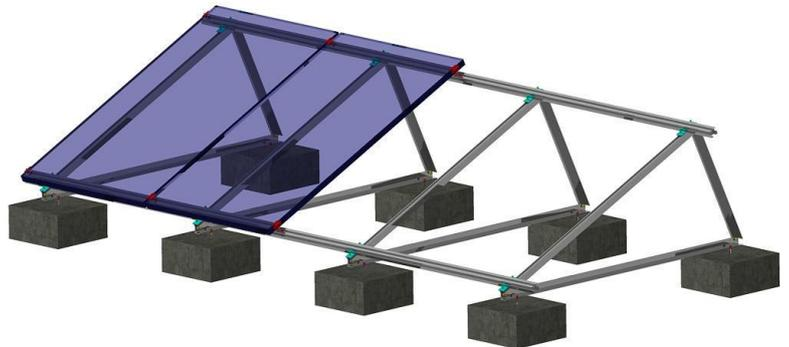
Estructura completa y de fácil instalación, para diferente grosor de módulo (35-40-45 y 50 mm). Diseñada para instalarse en superficie plana (Suelo o tejado plano). Puede llevar desde 1 a 20 módulos de diferentes medidas. La disposición del módulo solar es vertical.
