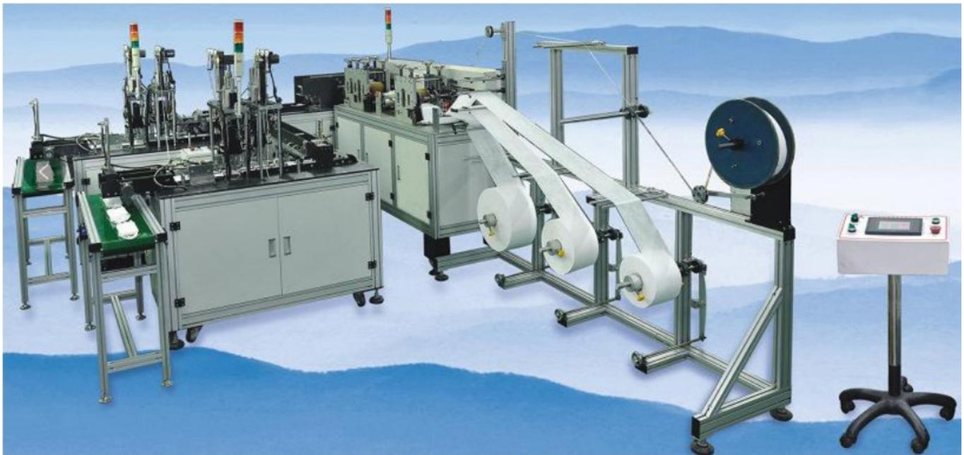
Esta máquina es una máquina totalmente automática para producir mascarillas con gomas - sujeción a las orejas. Incluye 1 juego de máquina de mascarillas faciales y 2 juegos de máquinas que colocan las gomas a las mascarillas.
